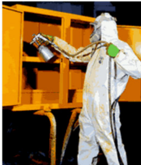
Pintor vistiendo los elementos de protección personal
