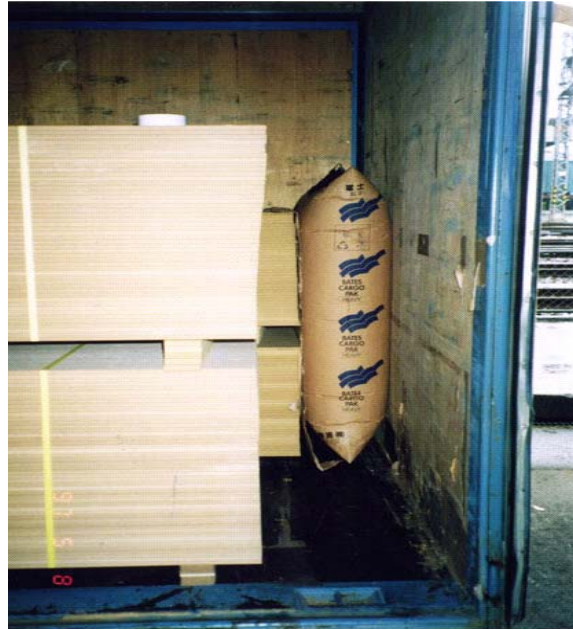
Imagen 3: Cojín de aire en un semirremolque
