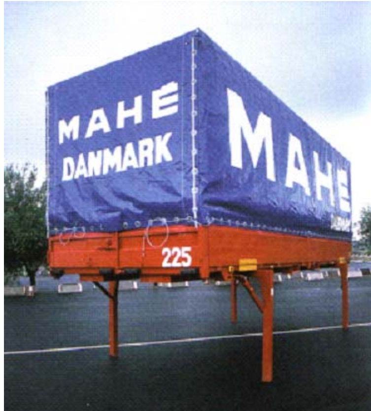
Imagen 10: Caja móvil colocada sobre los pies de soporte
