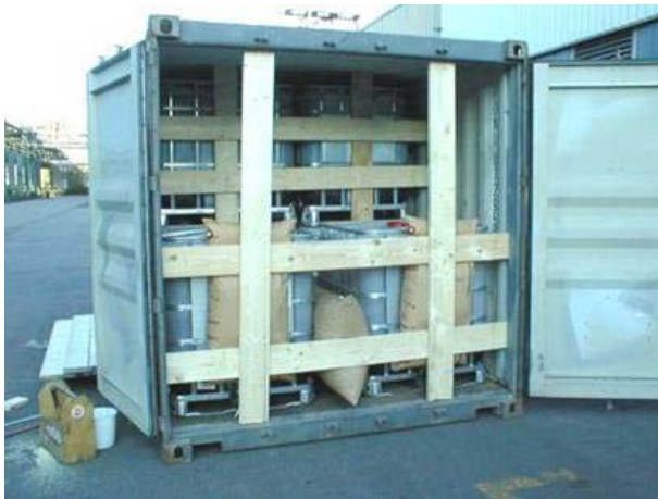
Imagen 15: Doble apilamiento de contenedores intermedios para graneles (IBCs) en un contenedor
