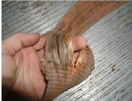
Imagen 20: Sus cinchas están gravemente dañadas. Sustitúyalas por otras nuevas.
