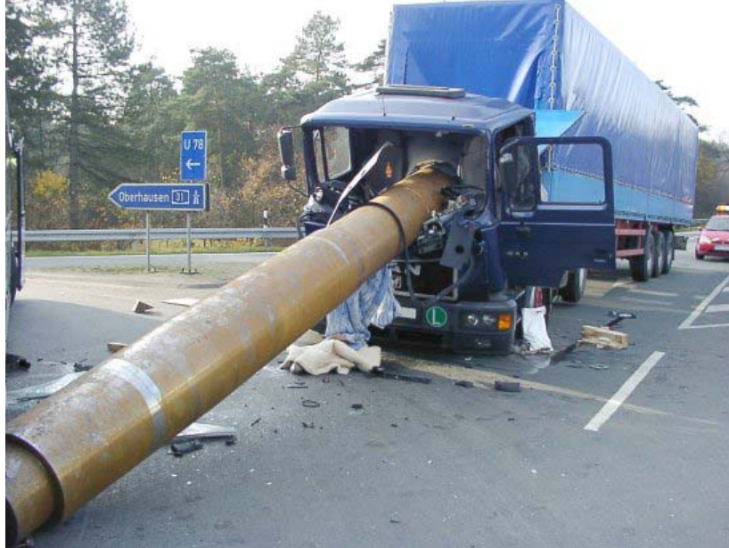
Imagen 1: Debido a un frenazo brusco, unos tubos de acero incorrectamente amarrados atravesaron la compuerta delantera y la cabina del conductor.
