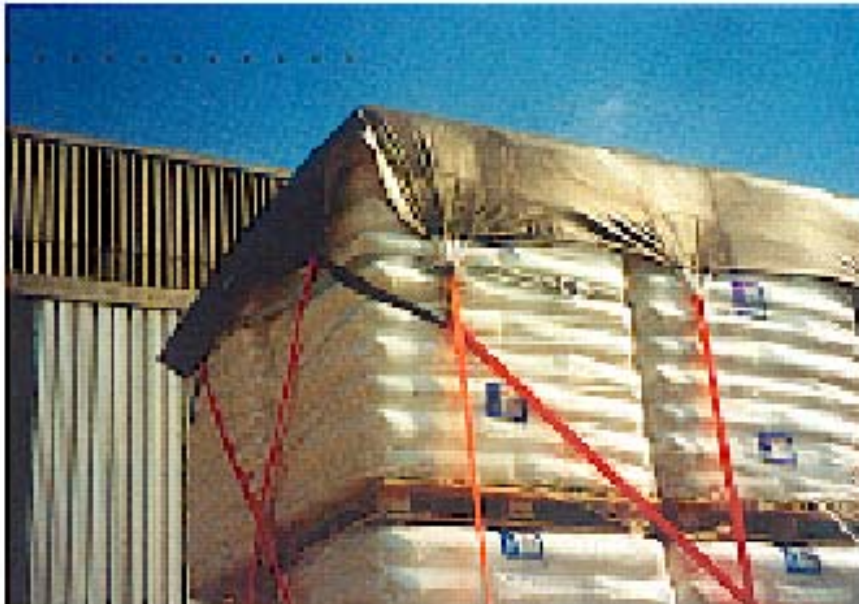
Imagen 26: Cubierta con trincas
