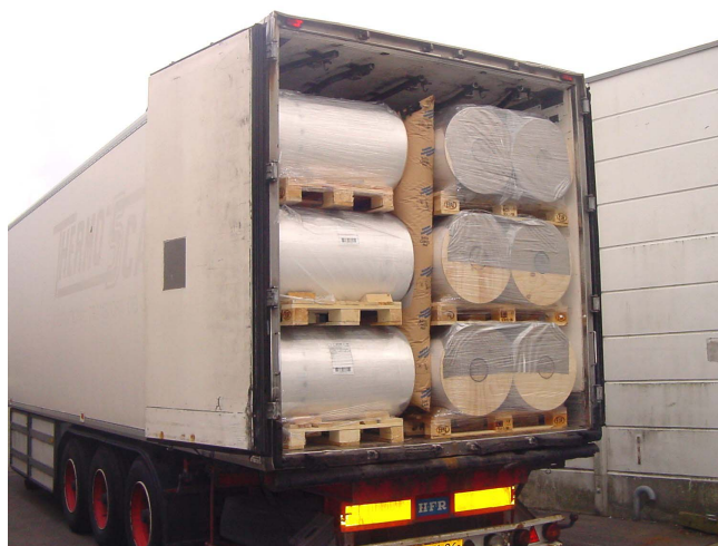
Imagen 2: Material de relleno entre las filas de carga
