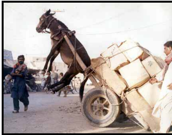
Imagen 5: Distribución incorrecta de la carga. Pueden producirse situaciones curiosas... o totalmente dramáticas.
