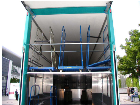
Imagen 7: Palé con ruedas, soportes laterales y barras de enganche.
