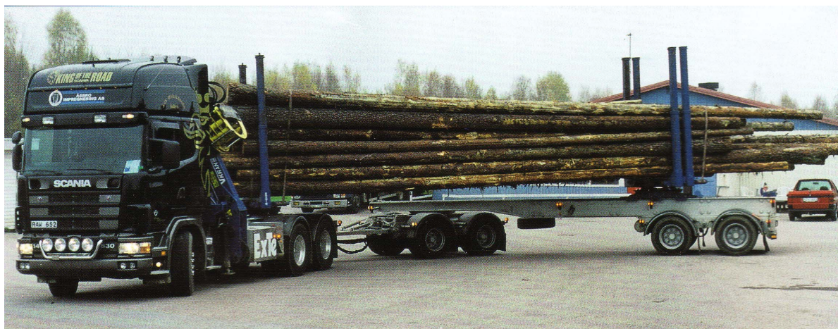
Imagen 7: Transporte de árboles enteros (se trata de un vehículo especial que no cumple la Directiva 96/53/CE)
